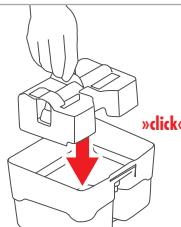
Helyezze bele felülről a vízszintszabályozó egységet a szennyvíztartályba.
